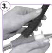
3. Schlauch auf die Nase stecken und seitlich in die Führungen des Werkzeuges ziehen.
