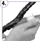
Schlauch ziehen, so dass er das Kabelbündel umwickelt.
