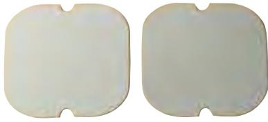
Die WLFİ Wärmeleitfolie ist ein glasfaserverstärktes siliciumorganisches Elastomer, das den thermischen Widerstand zwischen elektronischen Bauteilen und Kühlkörper effektiv senkt. Durch die sehr guten chemischen und physikalischen Eigenschaften ist WLFİ eine hervorragende Alternative zum traditionellen Glimmer.
